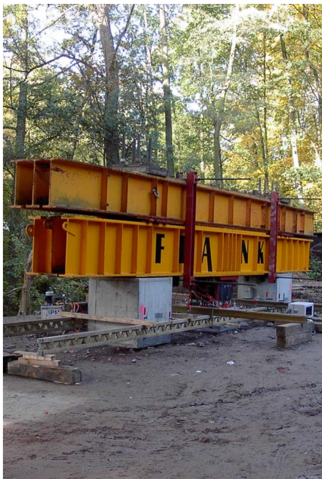
Abb. 2: Überblick und schematische Darstellung der axialen Pfahlprobelastung
