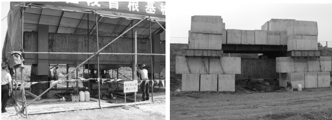
Bild 4 Pfahlprobelastung an Großbohrpfählen und Ramm- bzw. Schneckenortbeton-Pfählen
