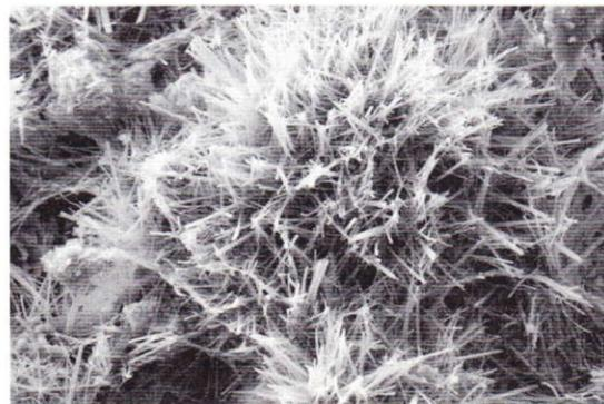
Bild 5. Mischung C, 180 Tage, BB = 105  $\mu\text{m}$ , (CSH).
