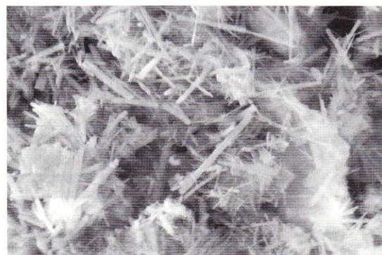
Bild 6. Mischung B, 360 Tage, BB = 23  $\mu\text{m}$ , (Ettringit-Kristalle).
