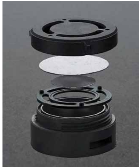
Festkörperspuredetektoren eignen sich zur Messung der jährlichen durchschnittlichen Radonkonzentration.
