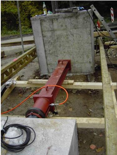
An beiden Standorten wurden jeweils ein Probepfahl und 2 Reaktionspfähle zur Einleitung der Kräfte in den Probepfahl vorgesehen. Bei den Pfählen handelt es sich um Bohrpfähle mit einem Durchmesser von  $D = 0,9$  m.
