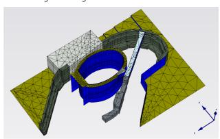
Als Stoffgesetz für den Baugrund aus Sanden und Kiesen wird ein Hardening Soil-Modell (elasto-plastisches Stoffgesetzt mit deviatorischer und volumetrischer Verfestigung) verwendet, welches Ent- und Wiederbelastungseffekte bzw. spannungsabhängige Steifigkeiten des Baugrundes berücksichtigt.
